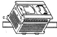
3) 在产品按压在[DIN导轨]上的状态下将[DIN导轨安装用挂钩(下图D)]锁住。
