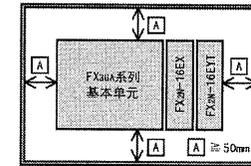
使用延长电缆配置成2段的构成
