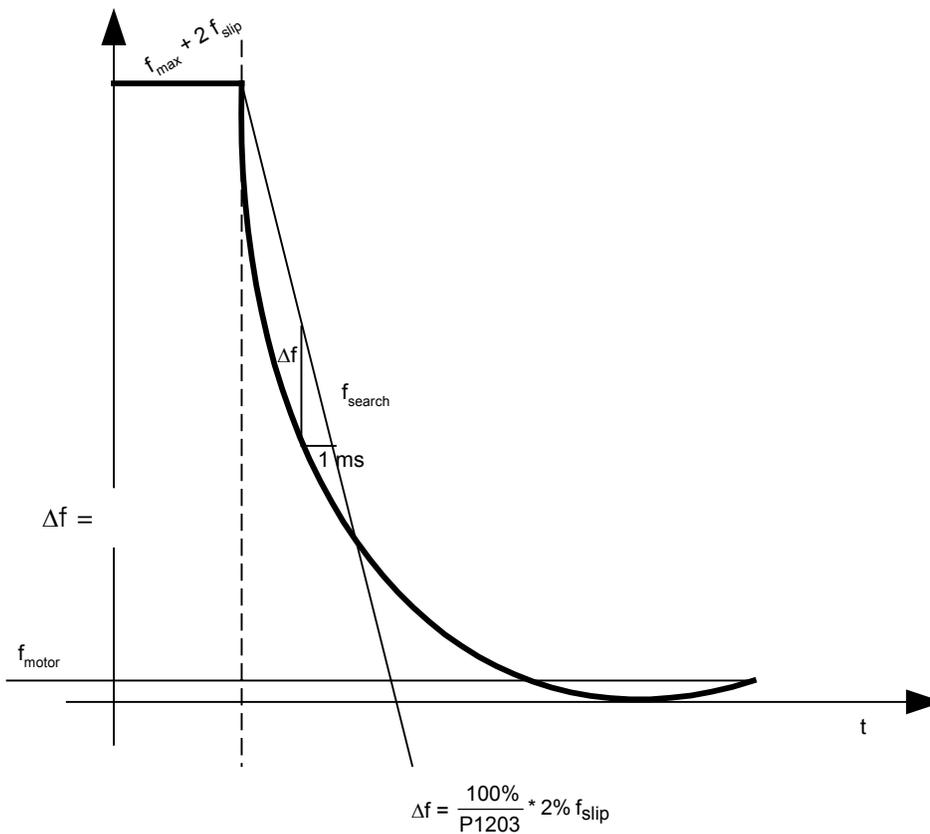
搜索时间是指, 从  $f_{max} + 2 \times f_{slip}$  (最大频率) + 2 x  $f_{slip}$  (滑差频率) 到 0 Hz 的全部频率进行搜索所要经过的时间。
