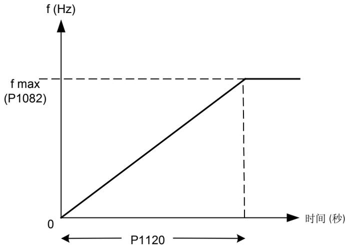
如果设定的斜坡上升时间太短，就有可能导致变频器跳闸（过电流）。
