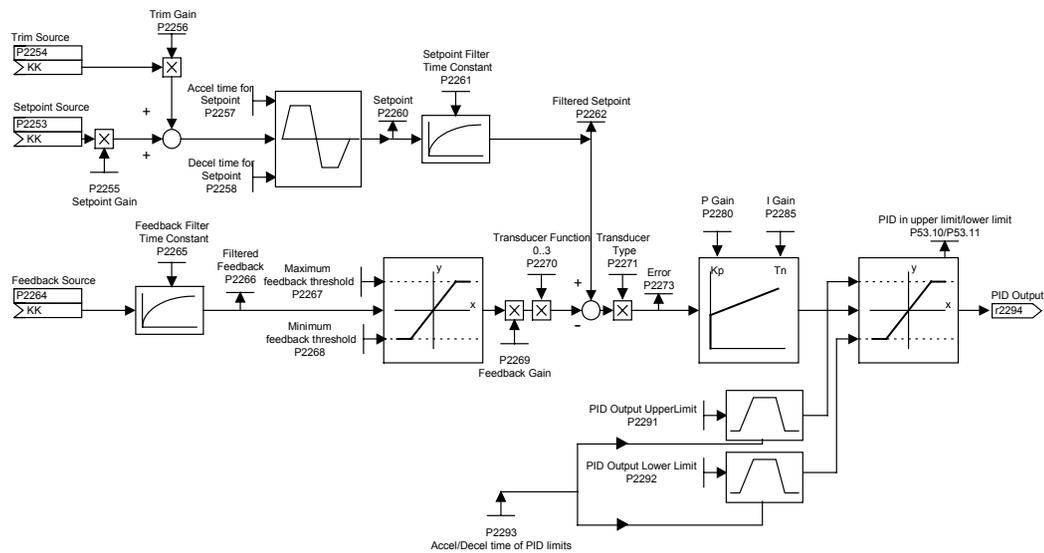
本参数（P2253）允许用户选择 PID 设定值的信号源。既可以用 PID 固定频率设定值，也可以用已激活的设定值来选 定数字的 PID 设定值。
