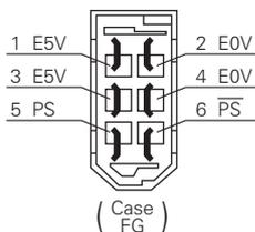
● 电机电缆中继用连接器的引线排列
