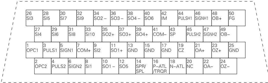
1. 接线时也可对连接器主体上标记的引线No.加以确认。
