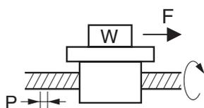
$$\text{移动转矩 } T_f = \frac{P}{2\pi\eta} (\mu gW + F)$$
