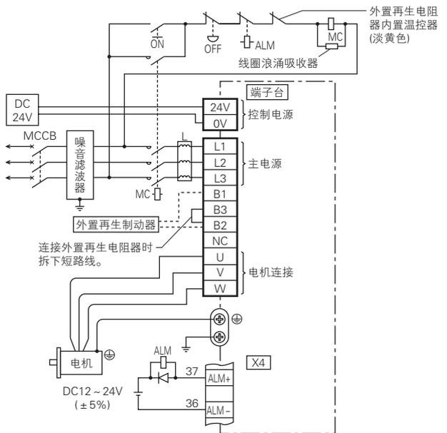
●使用<MSME(1.0kW ~ 5.0kW)、MDME、MGME、MHME>电机时的连接如下所示。
