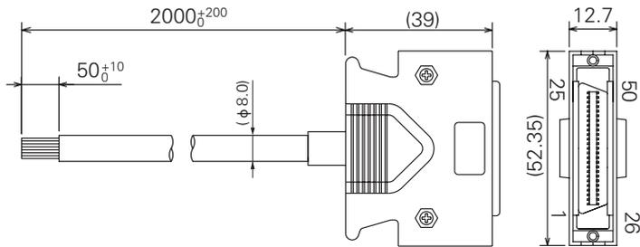
连接了长2m、芯线AWG28的电缆。
