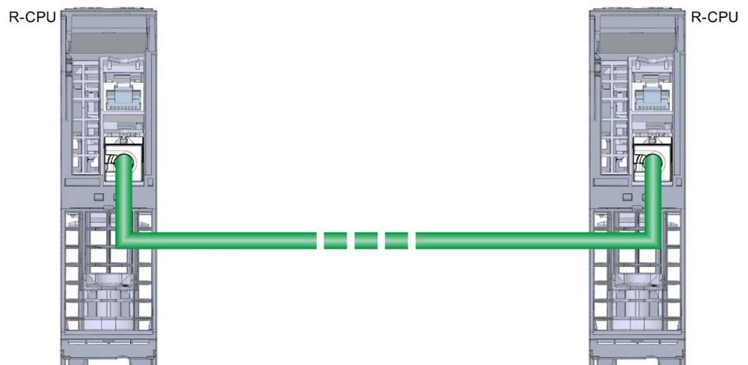
图 6-6 PROFINET 接口 X1 P2 R：连接 R-CPU（仰视图）
