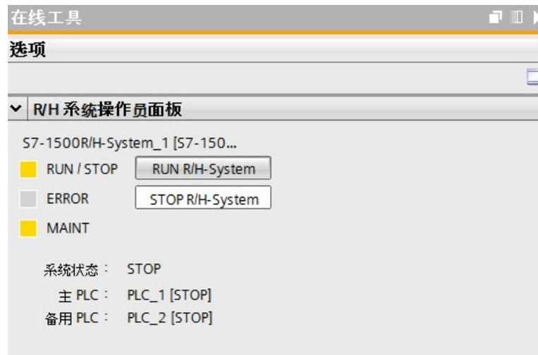
图 10-13 R/H 系统操作面板上的 STOP 系统
