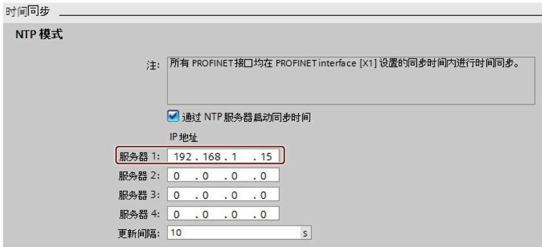
图 10-14 示例：组态 NTP 服务器
