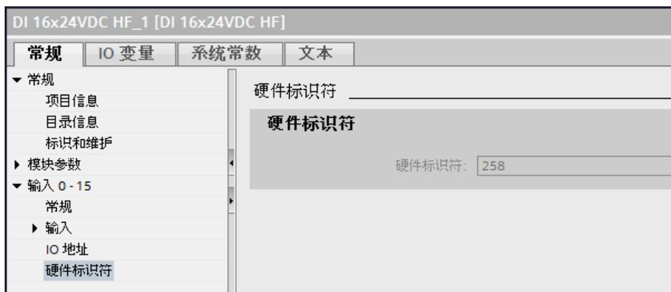
图 7-6 STEP 7 中的硬件标识符示例
