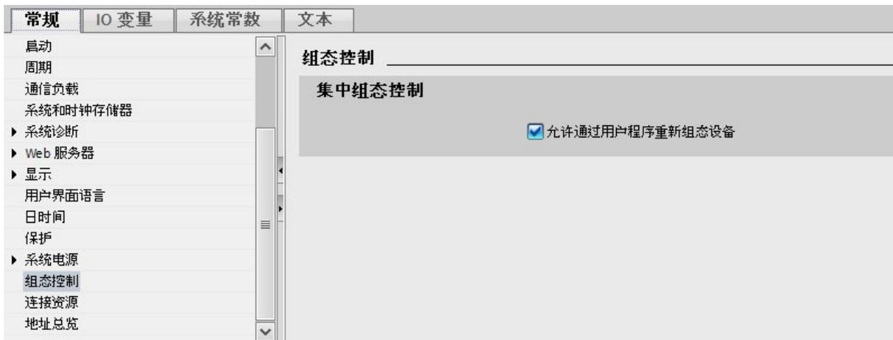
图 10-2 以 S7-1500 CPU 为例，启用组态控制
